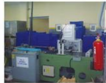
İç Kaplama Üretim Hattı: Verilen siparişe göre, PVC veya kağıt, dış yüzeyi lamine edilmiş mukavaranın iç yüzeyine lamine edilir. Günlük üretim kapasitesi 21.000 adettir.
